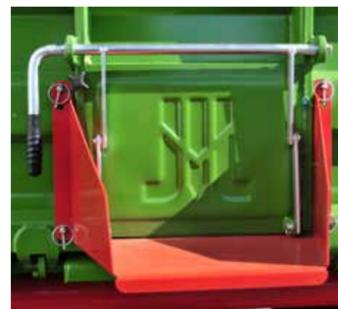
Auslaufsasse ermöglicht gezielte Entladung
