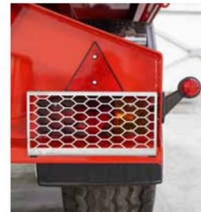
Rücklichter mittels Schutzgitter gesichert
