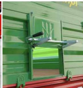
Rückwand mit dichtem Kornschieber
