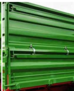
Spannleisten zur Stärkung der Bordwände
