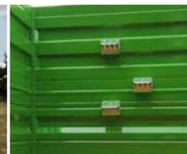
Bordwandstufen erleichtern den Zugang zur und aus der Ladekiste
