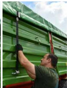
Rollplane mit Spanngurten zur Befestigung
