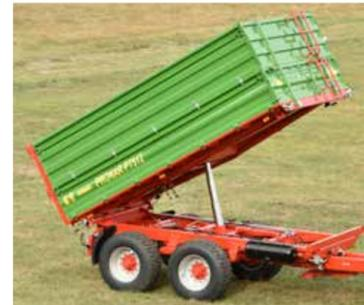
Effektive Entladung dank des zuverlässigen Teleskopzylinders
