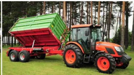
Ladekiste mit universalem Öffnungssystem und konischer Konstruktion (Heckverbreiterung um 50 mm)
