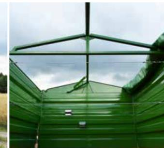
Spannseile zwischen den Mittelrungen als zusätzliche Verstärkung der Bordwände
