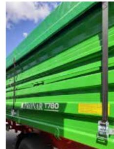
Verlässliche Befestigung der Plane mittels Zurrgurten
