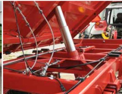
Robustes Fahrgestell durch rechteckige geschlossene Stahlprofile
